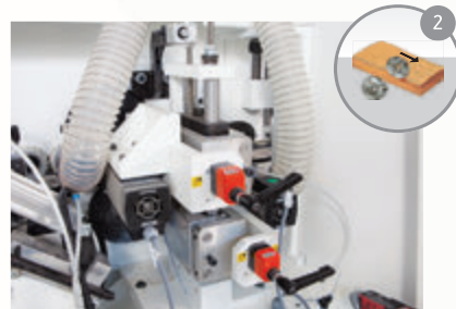
Freze Ünitesi / Milling Unit
