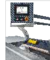
Testere Ünitesinin Otomatik Ağı Ayarı
