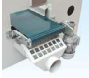
İmalat Sırasında Oluşan Talaşları Makine Dışına Taşıyan Talaş Konveyörü
