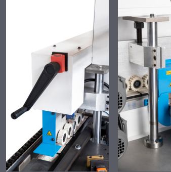
Üst Baskı Sistemi Machine Top Pressure System
