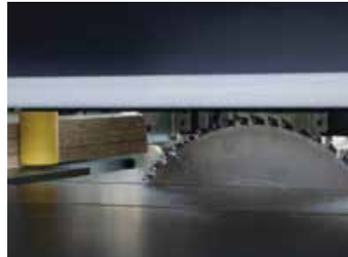
Kesilen parça yüksekliğine göre otomatik ayarlanan testere hızı Automatic regulation of cutting speed due to the panel height
