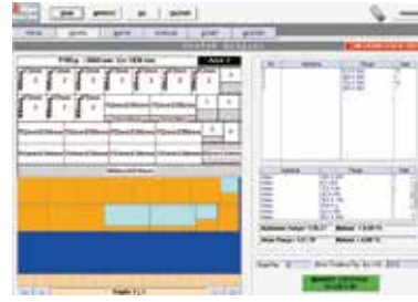
Otomatik Kesim, Optimizasyon ve Gerçek Zamanlı Etiket Uygulama Programı - Kesim Simülasyonu Automatic Cutting Program, Optimization Program with Real Time Label Printing Cutting Simulation
