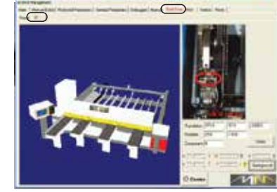
3 Boyutlu uyarı sistemi makinedeki arızaları gösterir. 3D Malfunction diagnosis
