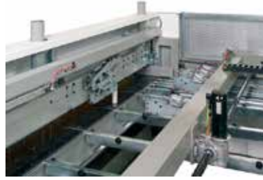
Güçlü Servo Motor ile Yüksek Hızda Pozisyonlama High speed positioning with strong servo pusher
